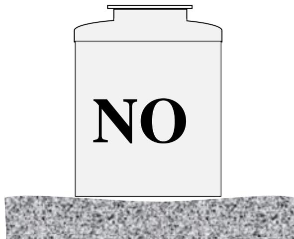
5.- En caso de que existiera desnivel, construir pilares armados de sustentación de mínimo 100mm mayores que los apoyos.
